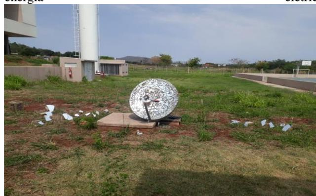
Figura 2. Conjunto de espelhos refletores acoplado ao reservatório de água. O objetivo é orientar os espelhos para concentrar a energia radiante emitida pelo sol em um recipiente capaz de acumular pressão. Fonte da imagem: autoria própria.
